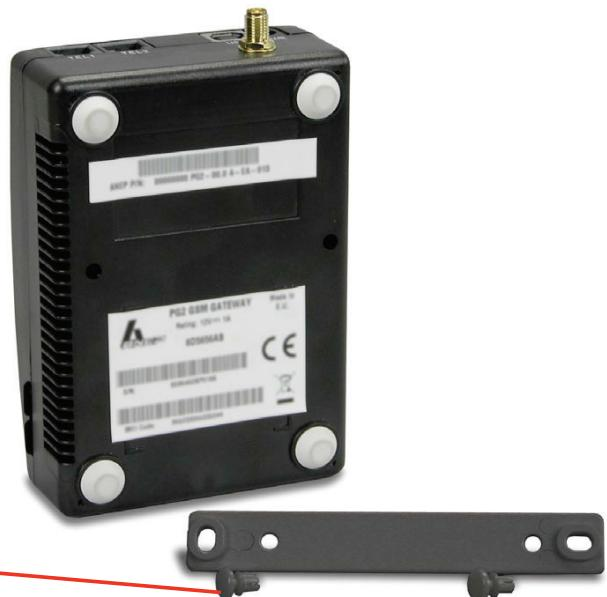
2. Voordat de beugel aan de wand wordt bevestigd, is het nodig hem aan het apparaat te verankeren met de **twee bevestigingsknoppen** in de verpakking.
