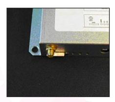
Installer l'antenne et brancher le câble d'alimentation. Le processus de démarrage peut nécessiter jusqu'à 30 secondes avant que la passerelle GSM établisse la liaison avec le réseau GSM.
