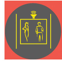
Bouton d'appel pour communication machinerie vers toit de cabine
