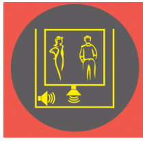
Bouton d'appel pour communication machinerie avec le technicien sous cabine
