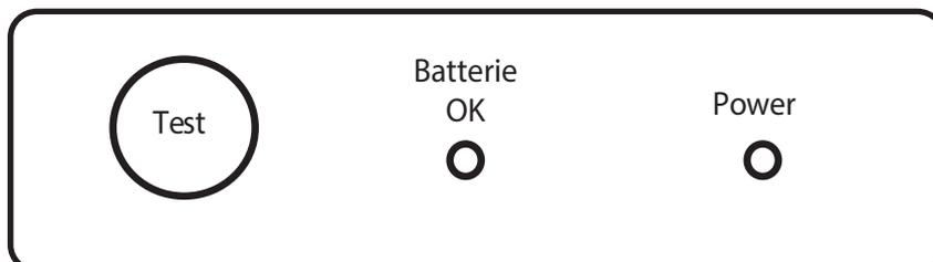
A l'appui du bouton test «**BP TEST BATTERIE**» le voyant vert «**BAT OK**» clignote (phase de contrôle de 5 à 15s), à l'issue de cette période, si la led verte «**BAT OK**» reste allumée la batterie est opérationnelle pour délivrer une autonomie minimum de 1 heure.
