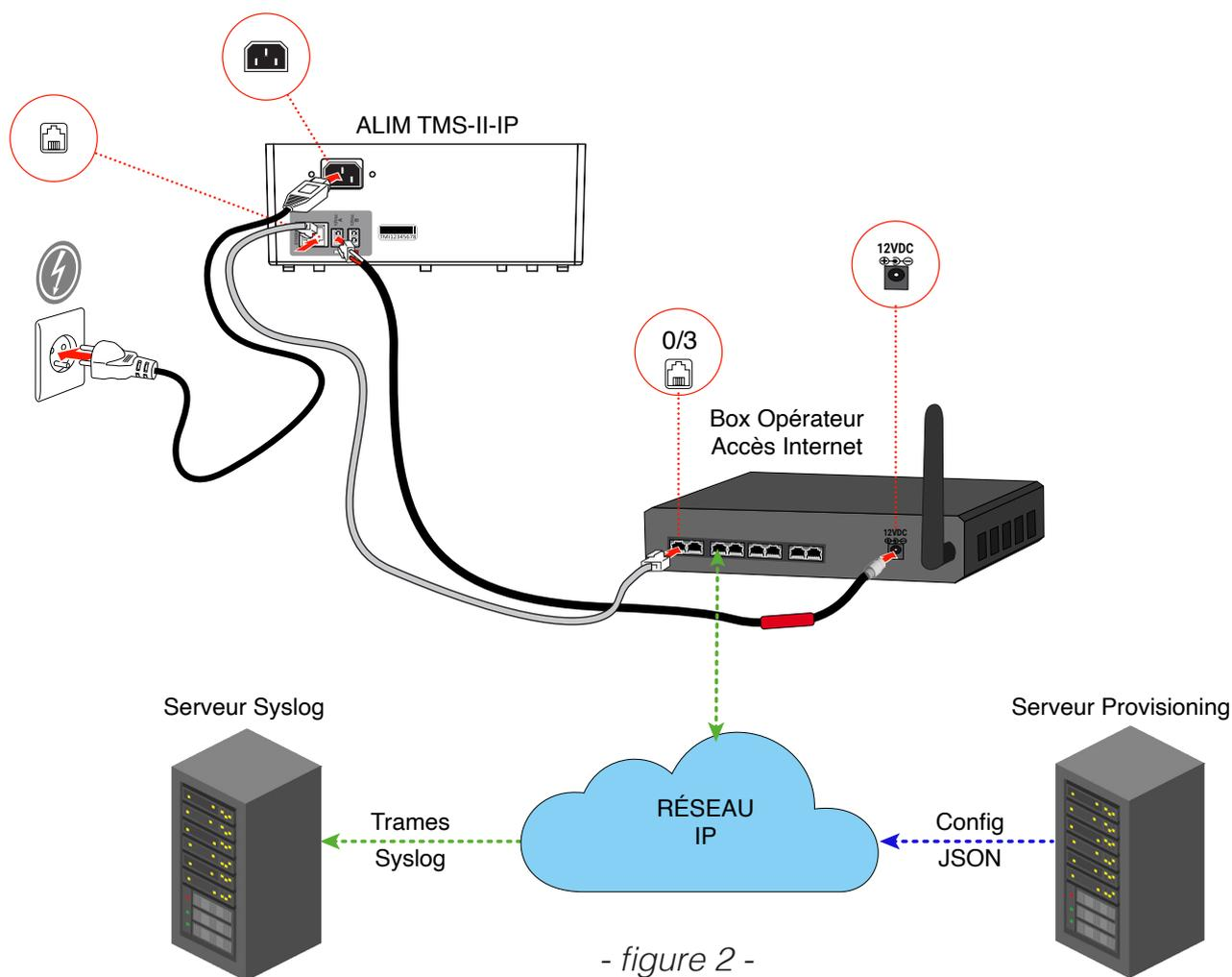
1. A la mise en service, l'alim TMS-II-IP se connecte au serveur ANEP de provisioning afin de récupérer sa configuration
